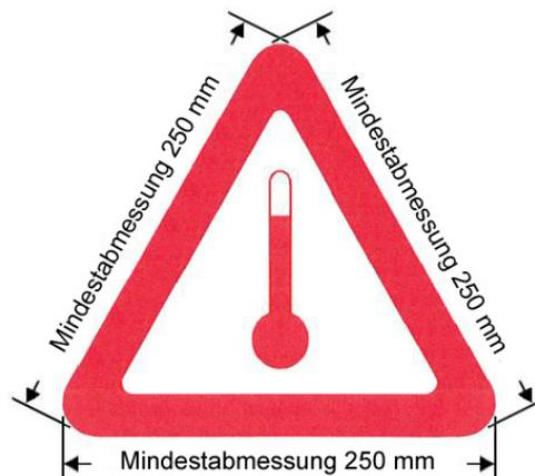
Kennzeichen für Beförderung bei erhöhter Temperatur
