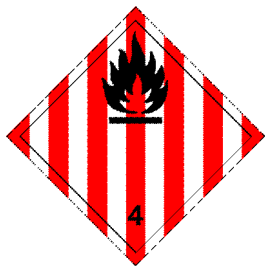
(Nr. 4.1) Symbol (Flamme): schwarz auf weissem Grund mit sieben senk- rechten roten Streifen; Ziffer «4» in der unteren Ecke
