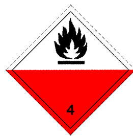
(Nr. 4.2) Symbol (Flamme): schwarz auf weissem (obere Hälfte) und rotem Grund (untere Hälfte); Ziffer «4» in der unteren Ecke
