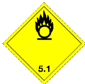
(Nr. 5.1) Symbol (Flamme über einem Kreis): schwarz auf gelbem Grund; Ziffer «5.1» in der unteren Ecke
