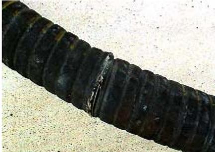
**Bild 16: Beispiel für einen beschädigten Schlauch.**
