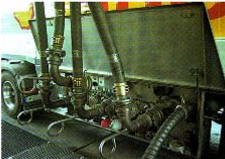
**Bild 4: Armaturenschrank für Bottom-Loading während der Befüllung. Rechts der Schlauch für die Dämpfeabsaugung.**
