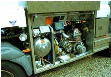
**Bild 8: Armaturenschrank eines Tankfahrzeuges zur Auslieferung von HEL. In der Mitte links ist die Additivierungsanlage erkennbar.**
