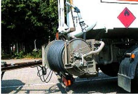
**Bild 7: Ausgeklappte hydraulisch betätigte Schlauchtrommel.**
