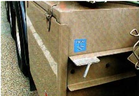
**Bild 12:** Erdungsanschluss am Tankfahrzeug mit Kennzeichnung, bestehend aus Lasche und Dorn für Erdungsstecker
