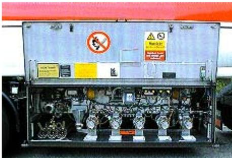
**Bild 5: Armaturenschrank. Unten links sind die quer zur Fahrtrichtung angeordneten Halterungen für die Abgabeschläuche erkennbar.**
