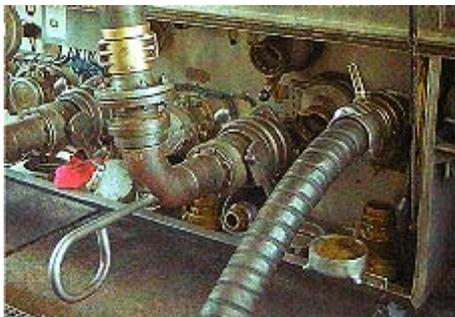
**Bild 19:** Zwei Befüllrohre sind angeschlossen, rechts die Gasrückführung mittels Schlauch.
