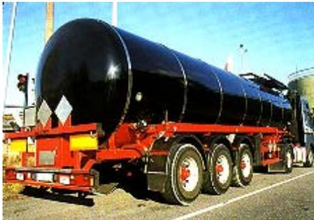
**Bild 9:** Tanksattelkraftfahrzeug für die Beförderung von Bitumen (zur Zeit des Fotos kein Gefahrgut, deshalb keine Kennzeichnung).
