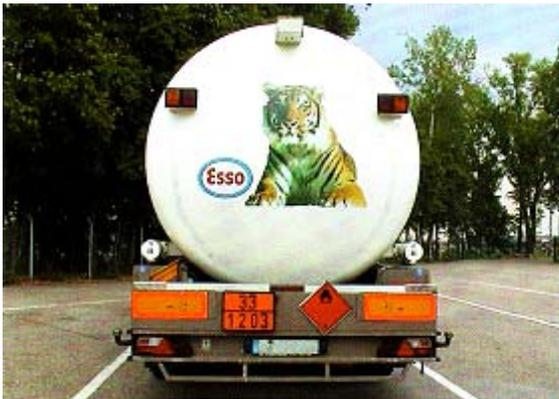
**Bild 24: Heckseite des Tankfahrzeuges mit Warntafel und Placard.**
