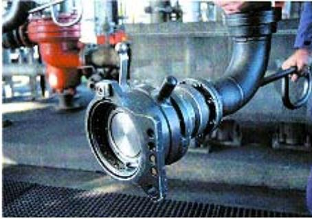
**Bild 20:** API-Kupplung (Landseite) im Detail.
