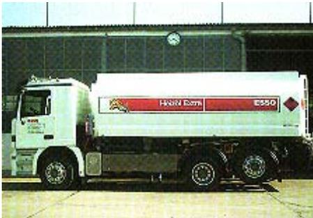
**Bild 6:** Tankfahrzeug für die Belieferung mit Heizöl extra leicht (HEL).
