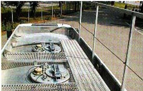
**Bild 11:** Laufsteg und Absturzsicherung einseitig vorhanden, so dass der Tkw nur für die Begehung von einer Seite geeignet ist.
