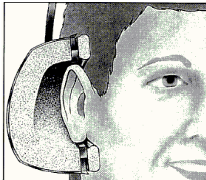
Bild 1: Aufbau eines Kapselgehörschützers mit Kopfbügel (Quelle: Bilsom)
